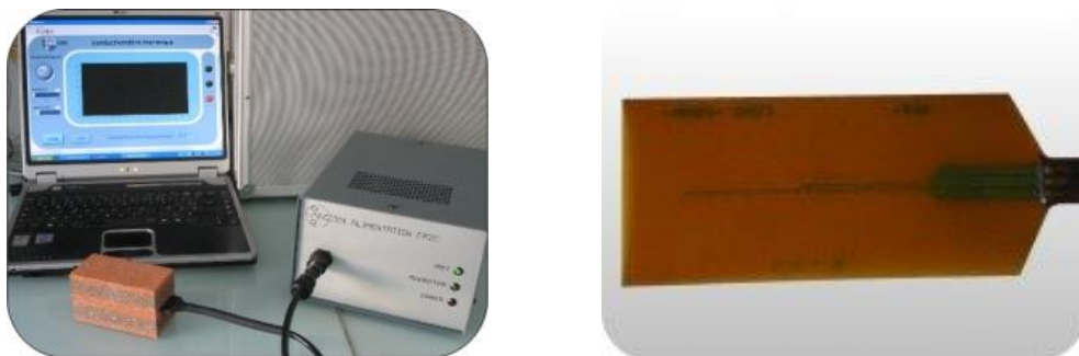
Figure 1: Dispositif de mesure de conductivité thermique par fil chaud.
